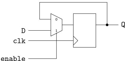
Lorsque le signal `enable` vaut 1, le signal D est présenté directement en entrée de la bascule D. Donc si un front montant se produit sur l'entrée d'horloge `clk`, la sortie Q de la bascule prendra la valeur de D.
